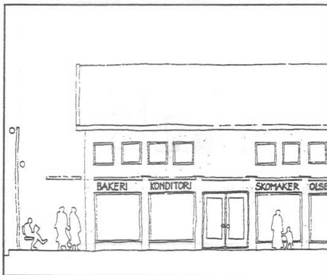
Skilting på vegg med veggfargen som bunn for skiltteksten
